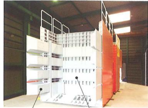
スライド式土留 隔壁
